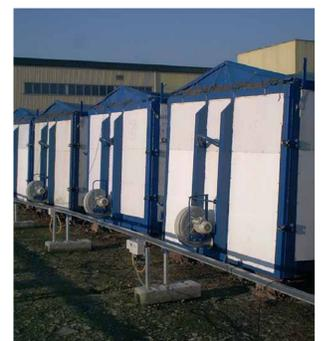
Die Kompostierung fand bis 2002 in offenen Rottemieten statt. Seit April 2002 geschieht die Kompostierung in geschlossenen Containern. Im Rahmen dieser Verfahrensänderung wurde die Materialsiebung am Ende der Rottetrommel eingestellt. Die Anlage wurde 2009 um eine Siebtrommel und elf Förderbänder reduziert. Die Materialsiebung erfolgt nun in der Verladehalle, bevor das Endprodukt für den Verkauf gelagert wird.
