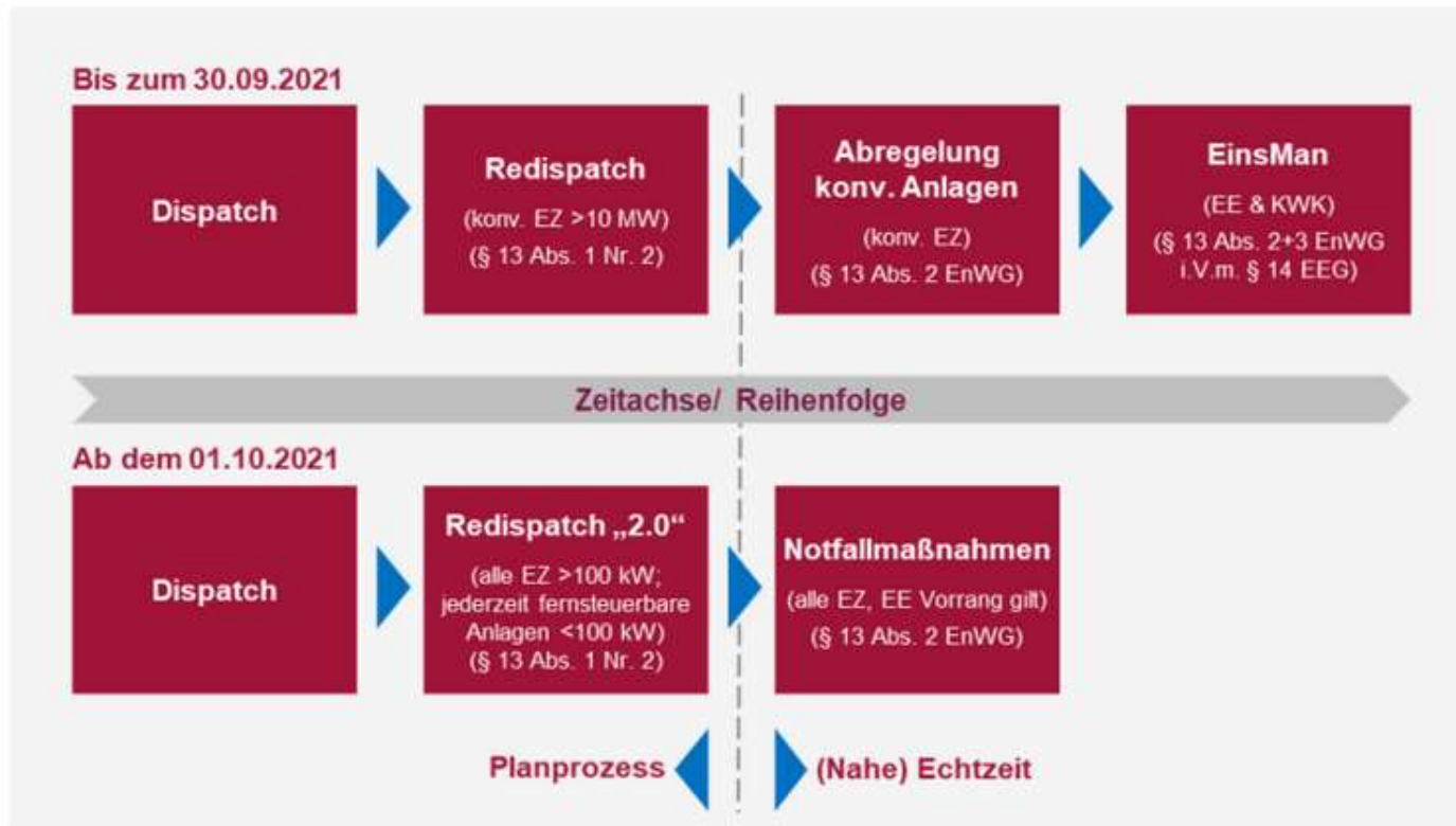
Abbildung: Vereinfachte Prozessdarstellung erzeugungsseitiger Maßnahmen zur Engpassbeseitigung durch den Netzbetreiber vor und nach Stichtag der Neuregelung
